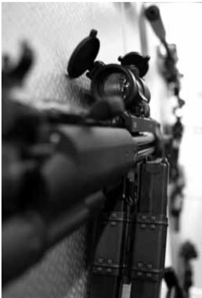
Eine Maschinenpistole Typ MP5 von Heckler & Koch, Kaliber 9 mm, mit speziellen Zubehörteilen ausgestattet, einschliesslich zusätzlichen Magazinen, einer Magazinkopplung, und einem Suchlicht unter dem Gewehrlauf.
