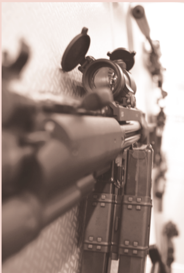
Un pistolet-mitrailleur Heckler & Koch MP5 de 9 mm, modifié au moyen d'accessoires tels que des chargeurs supplémentaires, un coupleur de chargeur et une lampe-torche sous le canon.
