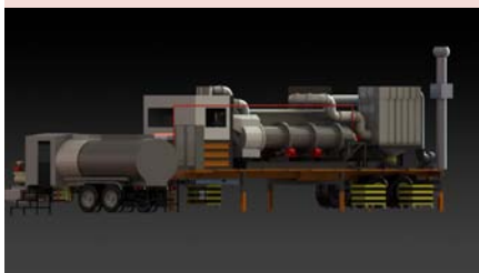
Мобилна ротационна пещ, конструирана от Esplodenti Sabino S.r.l. и AKANA Engineering Co. Ltd. © Esplodenti Sabino S.r.l./2012
