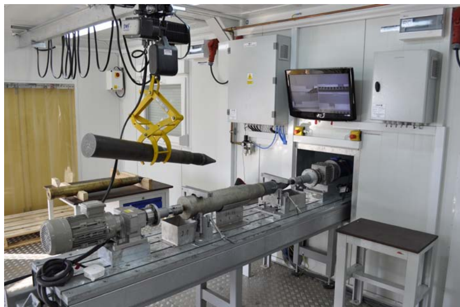
Компонент от транспортируемата система Planetarium на JAKUSZ за разглобяване на боеприпаси, обработващ 100 mm UBK8 снаряд. © JAKUSZ SZB/2011
